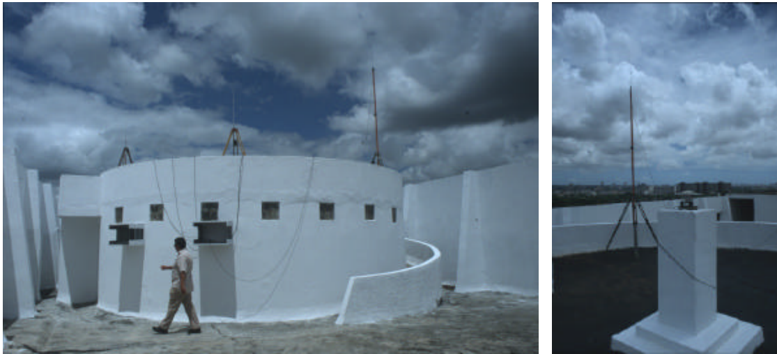
Abb.: Zentrale Referenzstation auf dem Messdach des Departamento de Engenharia Cartográfica mit UHF-Korrekturdatenempfängern (linkes Bild) und GPS-Referenzpunkt (rechtes Bild).
