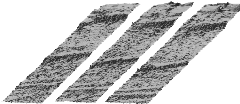
Abb. 3: Bildsequenz photogrammetrisch bestimmter Wasseroberflächen
