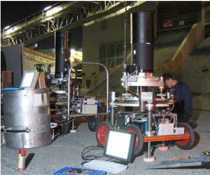
Beobachtung der Lotabweichung mit den digitalen Zenitkamarasystemen TZK2-D (rechts) und DIADEM (ETH Zürich) am Portal Faido des Gotthard-Basistunnels.
