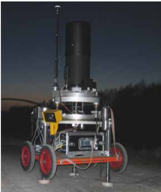
Das digitale Zenitkamarasystem TZK2-D bei Messungen am Mittel-landkanal über dem Salzstock Bokeloh nahe Steinhude.
