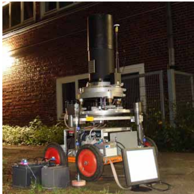
Das Digitale Zenitkamasystem TZK2-D während Dauerbeobachtungen an der Universität Hannover
