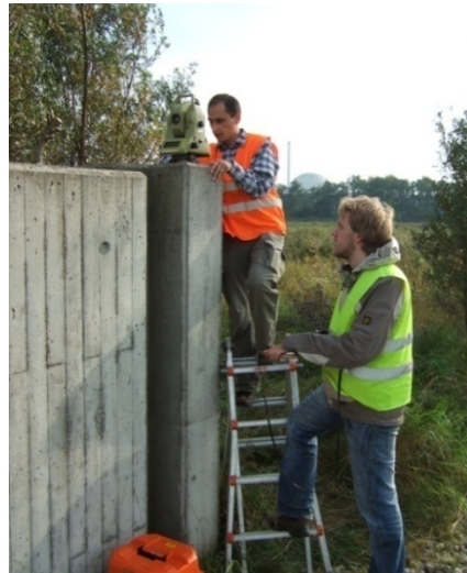
Durchführung des Feinnivellements und der tachymetrischen Beobachtungen
