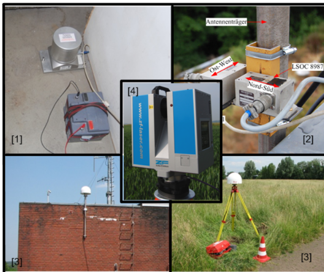
Monitoring mit unabhängigen geodätischen Sensoren (Zwei-achsneigungsmesser [1], Ein-achsneigungsmesser [2], GPS [3], Terrestrischer Laserscanner [4])
