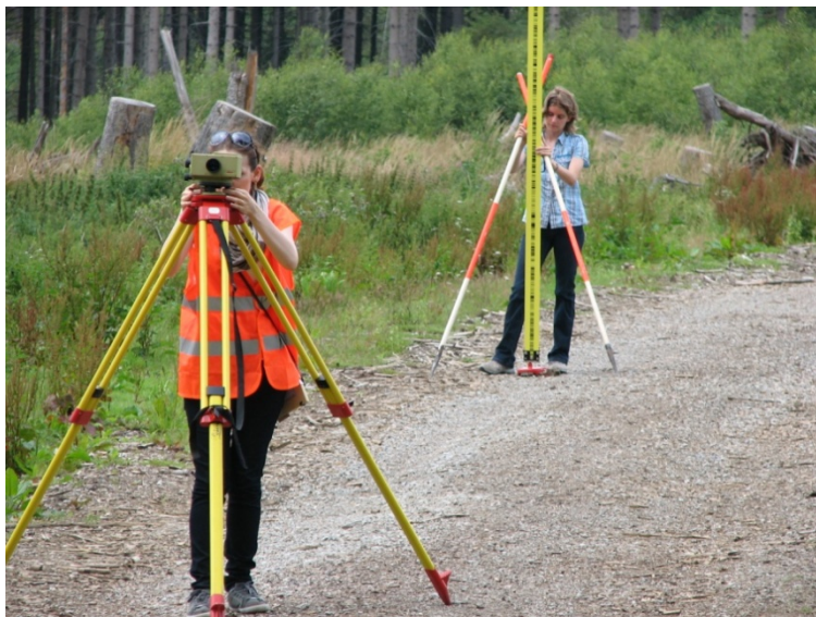
PRÄZISIONSNIVELLELEMENT FÜR DEN ANSCHLUSS DER GNSS-STATIONEN AN DAS DHHN92
