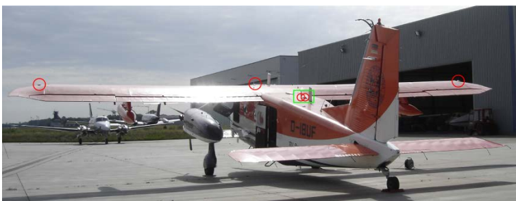
FLUGVERSUCHSTRÄGER D-IBUF DES INSTITUTS FÜR FLUGFÜHRUNG DER TU BRAUNSCHWEIG MIT MARKIERUNG DER ANTENNENPOSITIONEN
