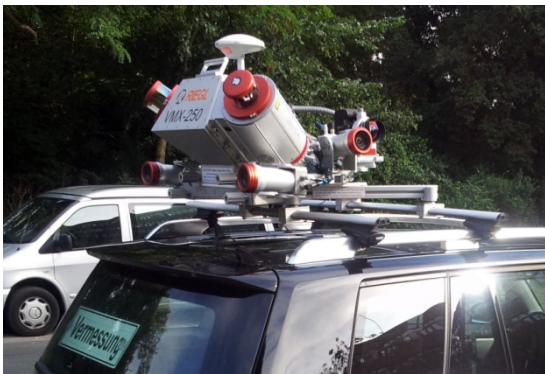
MOBILES LASERSCANNING-SYSTEM BEI EINER TESTFAHRT (LINKS) UND RESULTIERENDE PUNKTWOLKEN (MITTE UND RECHTS).
