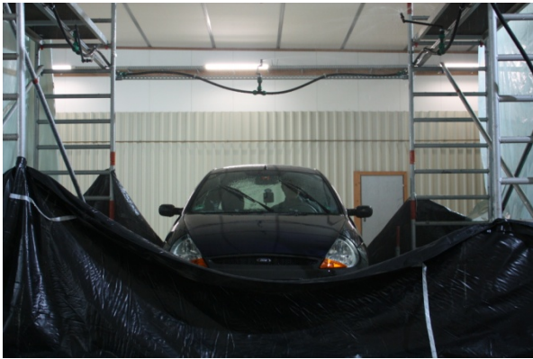
ABBLDUNG 1: LABOREXPERIMENT ZUR ERMITTLUNG FUNKTIONALER ZUSAMMENHÄNGE ZWISCHEN WISCHERFREQUENZ UND NIEDERSCHLAGS-INTENSITÄT
