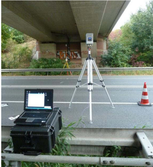
TLS-STANDPUNKT UNTER DER BRÜCKE
