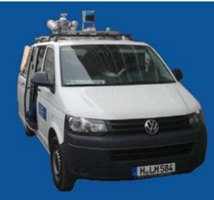
Fahrzeug mit MMS und Sensorplattform
