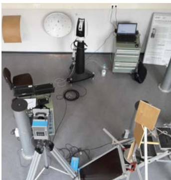
Anordnung der Sensoren bei der Kalibrierungsmessung
