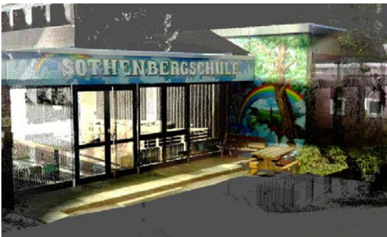
3D-Punktwolke der Sothenbergschule erfasst mit der Leica MultiStation 50
