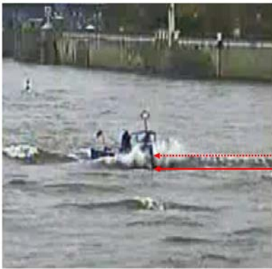
Höhe Bug: 1020 mm, 50% davon ist Wellenhöhe = 510 mm
