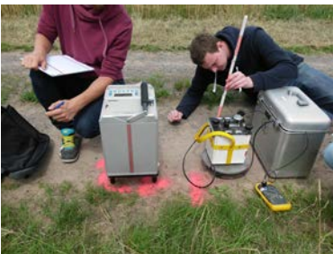
Relativgravimetrische Vermessung entlang des Schwereprofils mit den Instrumenten Scintrex CG3M-4492 und LCR G79
