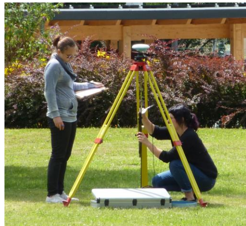
MESSUNGEN IN BAD FRANKENHAUSEN MIT RELATIVGRAVIMETRIE (LINKS) UND GNSS (RECHTS).
