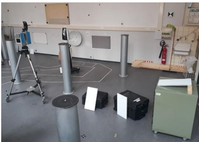
ANORDNUNG DER REFERENZEbenen FÜR DIE KALIBRIERUNG DES K-TLS BASIERTEN MSS
