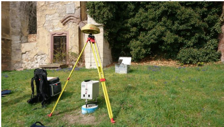
SIMULTANE DATENERHEBUNG RELATIVER GRAVIMETRIE UND GNSS IN BAD FRANKENHAUSEN, APRIL 2017
