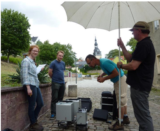
MESSUNGEN IN BAD FRANKENHAUSEN MIT RELATIVGRAVIMETRIE (LINKS) UND GNSS (RECHTS).
