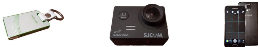
ABBILDUNG 1: VERWENDETE SENSOREN ZUR ERFASSUNG HOCHGENAUER SPIELER-TRAJEKTORIEN: GPS-LOGGER, ACTION-KAMERAS BZW. SMARTPHONES (V.L.N.R.).
