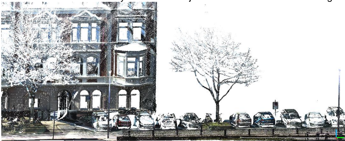
ABBILDUNG 4: URSPRÜNGLICHE PUNKTWOLKE EINES DATENSATZES, EINGEFÄRBT NACH DEN FARBWERTEN DER BILDER DER KAMERAS DES MOBILE-MAPPING-SYSTEMS.
