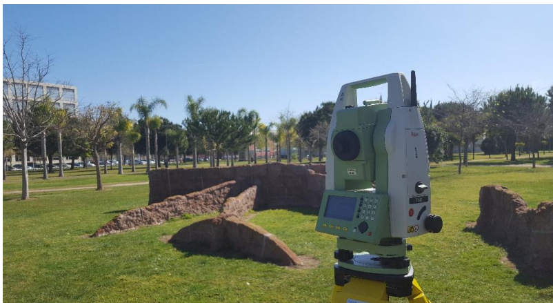
DAS 'BAUDENKMAL' WIRD TACHYMETRISCH AUFGENOMMEN.
