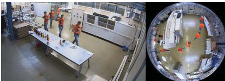
LINKS: MEHRFACHBELICHTUNG MIT KLASSISCHER KAMERALINSE. DIE PERSON KANN NUR AUS DER VORDERANSICHT ANALYSIERT WERDEN. RECHTS: MEHRFACHBELICHTUNG MIT EINER FISCHAUGENLINSE (NADIR). UNTERSCHIEDLICHE ANSICHTEN STEHEN FÜR DIE WIEDERERKENNUNG IN EINER WEITEREN KAMERA ZUR VERFÜGUNG.
