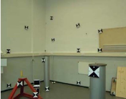
TESTFELD FÜR DIE KALIBRIERUNG ZWISCHEN KAMERA UND TLS IM LABOR DES GIH (FOTO P. LIPPMANN)
