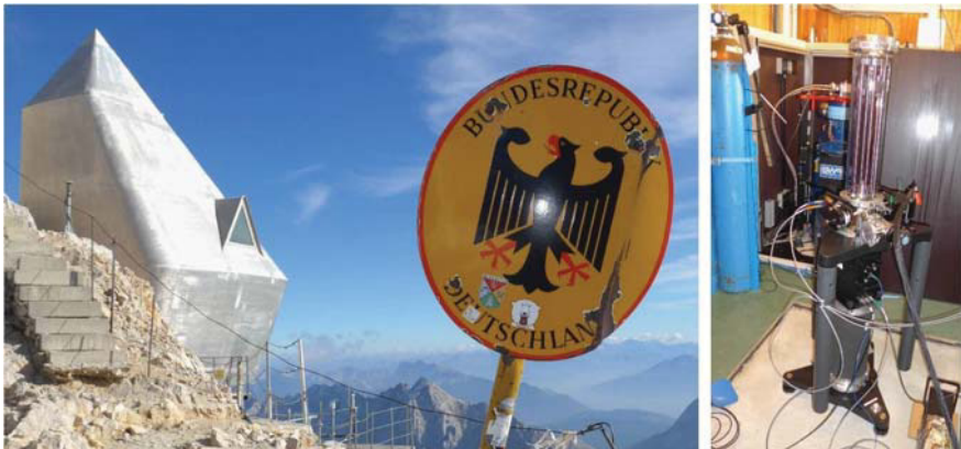
DIREKT AN DER GRENZE ZU ÖSTEREICH IST DAS NEUE OBSERVATORIUM DES GFZ POTSDAM EINGERICHTET WORDEN. LINKS SIEHT MAN IM VORDERGRUND DAS ABSOLUTGRAVIMETER DES IFE/LUH UND IM HINTERGRUND DAS HELIUM GEKÜHLTE SUPRALEITGRAVIMETER (FOTOS L. TIMMEN)
