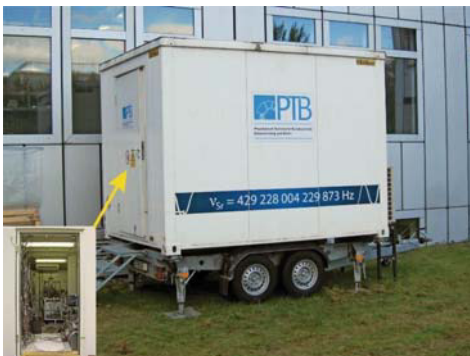
DIE NEBENSTEHENDE ABBILDUNG ZEIGT DEN CONTAINER MIT DER TRANSPORTABLEN OPTISCHEN UHR DER PTB IN GARCHING, DER VOM IfE EINGEMESSEN WURDE.
