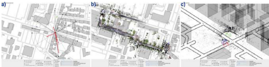
FORSCHUNGSDATENMANAGEMENT IM GRK I.C.SENS. IN EINEM WEB-INTERFACE KÖNNEN MESSDATEN GEZIELT GESUCHT UND VISUALISIERT WERDEN. A) MESSFAHRZEUG IFE, DATEN GNSS EMPFÄNGER, B) MESSFAHRZEUG IKG, DATEN RIEGL-SYSTEMS, C) MESSFAHRZEUG GIH, DATEN VELODYNE LASERSCANNERS.
