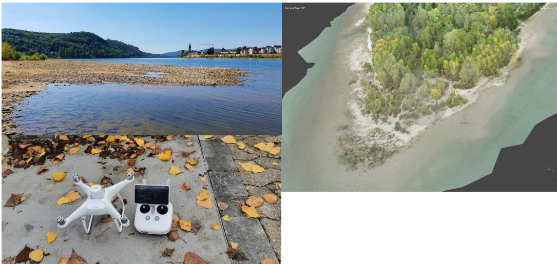
3D-ERFASSUNG VON FLACHWASSERBEREICHEN AN DER RHEININSEL NIEDERWERTH [BAFG, 2020]
