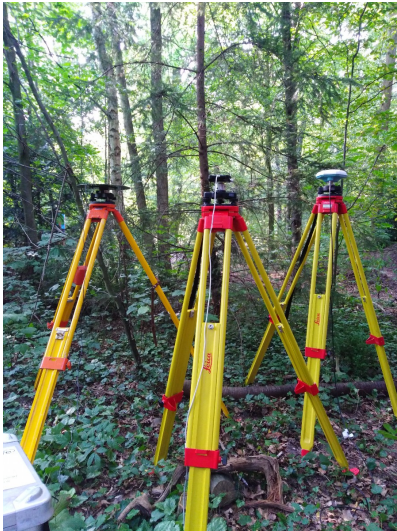
MESSAUFBAU ZUR UNTERSUCHUNG DES EINFLUSSES VON BELAUBUNG AUF DEN GNSS SIGNALEMPFANG.
