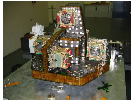
GOCE-Satellit und dreiachsiges GOCE-Gravitationsgradiometer [Quelle: ESA]
