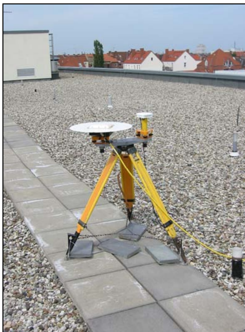
Testaufbau der GOKA und Trimble Ausrüstung zur Qualitäts- beurteilung der GOKA-Daten
