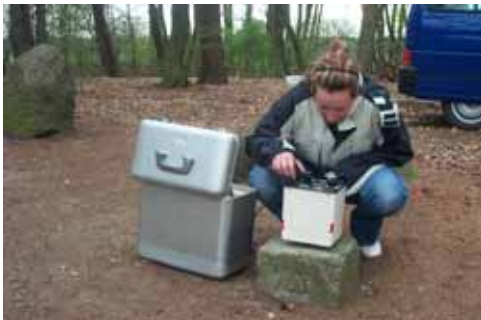
Gravimetrische Bestimmung des Punktes TP 2323-53 bei Visselhövede.
