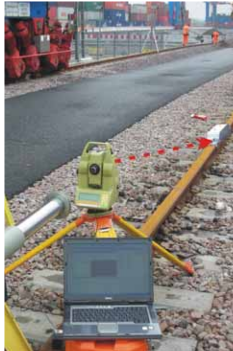
Kinematische Überwachung von Kranbahnschienen
