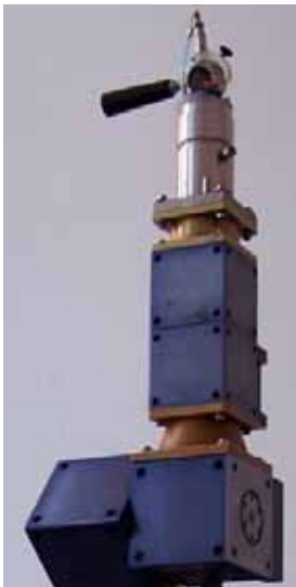
IfE-Roboter mit CCR bei der Neukalibrierung
