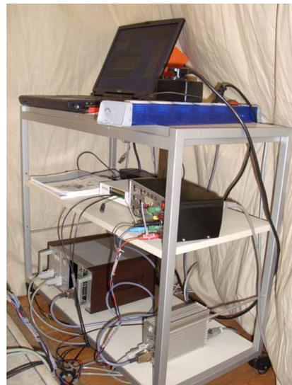
*Vom BKG entwickelte automatische Messplattform zur Bestimmung von vertikalen Schweregradienten. Links: Plattform mit Relativgravimeter Scintrex CG-5 in unterer Position. Rechts: Elemente zur Steuerung der Gradientenmessplattform.*
