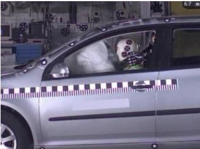
Bei der dreidimensionalen Vermessung von Crashversuchen ist die Erfassung der Fahrzeuginsassen während des Aufpralls sowie die Position der Airbags von großer Bedeutung. Mit dem geplanten Messverfahren und Messsystem wird eine vollständige und genaue dreidimensionale Erfassung der Situation zu jedem
