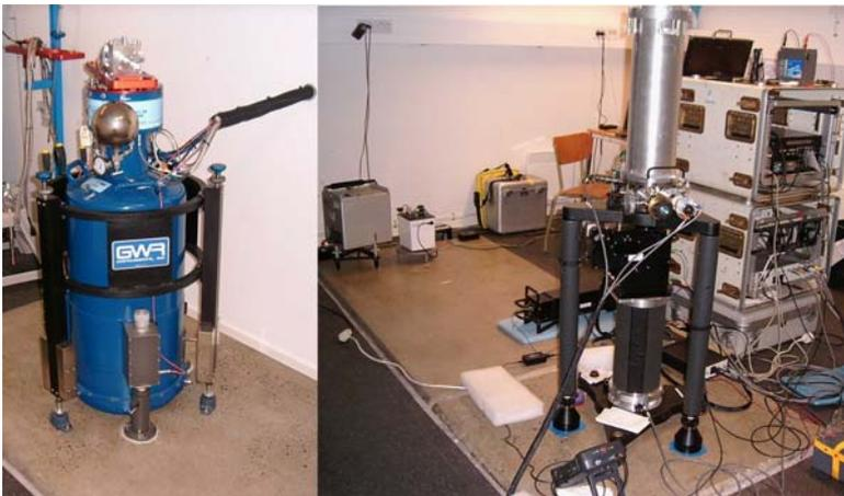
*Das Supraleitgravimeter GWR054 und das Absolutgravimeter FG5-220 während der Parallelregistrierung in Onsala.*
