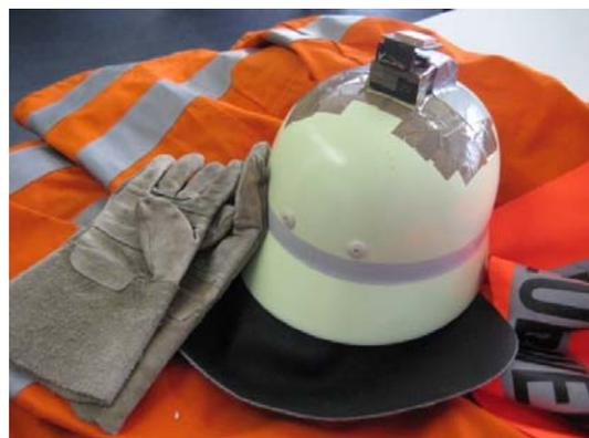
*Links: Aufbau eines Sensorknotens: SunSPOT mit GPS-Empfänger, Rechts: Montage des SPOTs auf dem Feuerwehrhelm*
