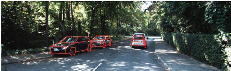
**DETEKTIERTE FAHRZEUGE UND DIE EINGEPASSTEN 3D-FAHRZEUGMODELLE**
