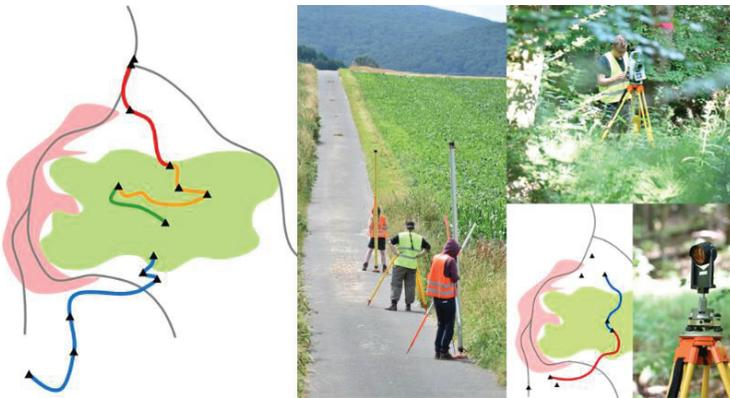
**DURCHFÜHRUNG DES NIVELLEMENTS: ÜBERSICHTSSKIZZE DER NIVELLEMENTSZÜGE UND DURCHFÜHRUNG DER MESSUNG (LINKS UND MITTE); MESSUNG DES POLYGONZUGES: STANDPUNKT DES TACHYMETERS (OBEN RECHTS), ZIELPUNKT UND ÜBERSICHTSSKIZZE (UNTEN RECHTS)**
