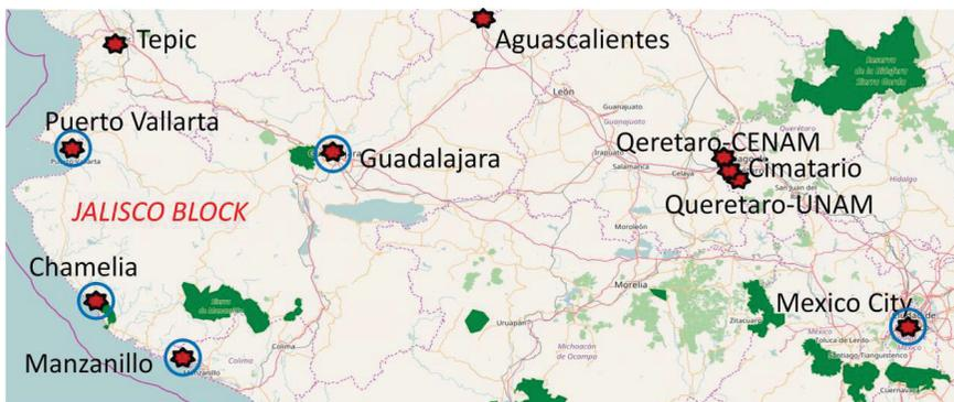
**MESSSTATIONEN, IN DENEN 2016 MIT DEM FG5X-220 DES INSTITUTS FÜR ERDMESSUNG ABSOLUTE SCHWERBESTIMMUNGEN VORGEGOMMEN WURDEN (AUSNAHME: CIMANTARIO BEREITS IN 2015). DIE MIT BLAUEN KREISEN GEKENNZEICHNETEN PUNKTE WURDEN ERSTMALIG MIT DEM FG5-111 (NOAA) IN 1996 BESSETZT**
