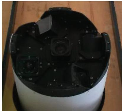
**DIE FÜNF KAMERAS DER LEICA RCD30**
