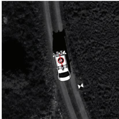
BEGLEITFAHRZEUG MIT PASSPUNKT AUF DEM DACH BEIM MAPKITE-SYSTEM [QUELLE: GEONUMERICS]
