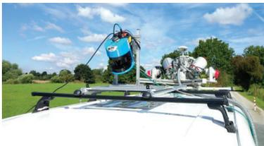
**AUFBAU DES MESSSYSTEMS MIT AUTOMOTIVE-LASERSCANNER (VORNE) UND KOMMERZIELLEM MOBILE-MAPPING-SYSTEM (HINTEN).**
