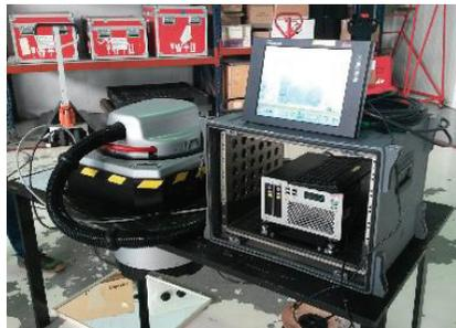
**STEUERUNGSSYSTEM DER LEICA RCD30**
