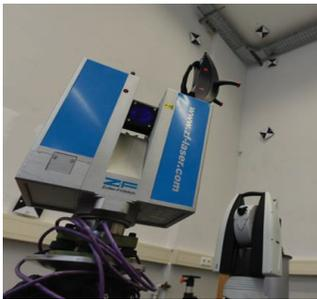
**DAS MSS, BESTEHEND AUS LASERSCANNER UND LASERTRACKER IN VERBINDUNG MIT EINER T-PROBE. (FOTO U. STENZ)**
