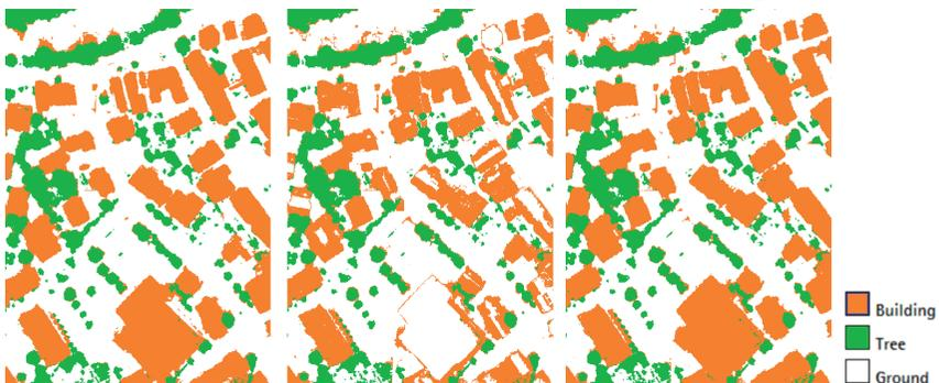
**EXEMPLARISCHE KLASSIFIKATIONSERGEBNISSE: KLASSIFIKATOR TRAINIERT UND ANGEWENDET AUF ZIELDOMÄNE OHNE TRANSFER-LERNEN (BESTMÖGLICHES ERGEBNIS MIT DEM VERWENDETEN KLASSIFIKATOR) (BILD LINKS); KLASSIFIKATOR TRAINIERT AUF QUELLOMÄNE UND ANGEWENDET AUF ZIELDOMÄNE OHNE TRANSFER-LERNEN (AUSGANGSSITUATION FÜR TRANSFER-LERNEN) (BILD MITTE); KLASSIFIKATIONSERGEBNIS NACH TRANSFER-LERNEN (BILD RECHTS). (GETESTET AUF: POTSDAM DATA SET AUS DEM ISPRS 2D SEMANTIC LABELLING CONTEST)**
