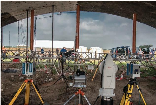
**DETAILANSICHT DER GEWÖLBEUNTERSEITE MIT DEN EINGESETZTEN GEODÄTISCHEN SENSOREN**
