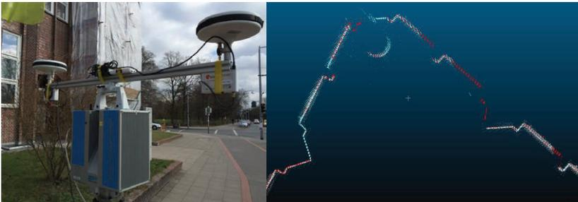
**PROTOTYP ZUR DIREKTEN GEOREFERENZIERUNG MIT GNSS (LINKS) ERGEBNIS DER REGISTRIERUNG MIT ICP (RECHTS)**
