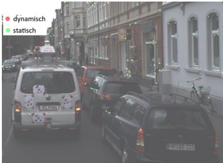
EINTEILUNG VON VERKNÜPFUNGSPUNKTEN IN STATISCHE UND DYNAMISCHE PUNKTE
