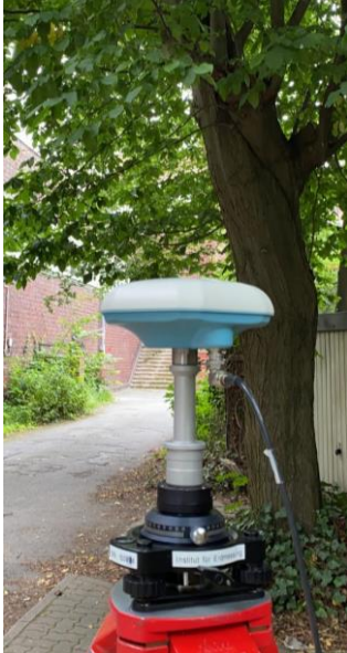
MESSUNG DER NULLBASIS-LINE UNTER HERAUSFORDERNDEN BEDINGUNGEN
