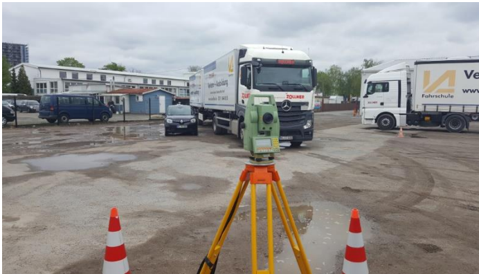
AUFBAU DER MESSUNG ZUR UNTERSUCHUNG DES EINFLUSSES EINES LKWs AUF MULTI-GNSS SIGNALE
