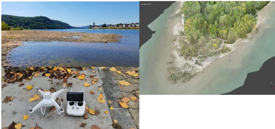
3D-ERFASSUNG VON FLACHWASSERBEREICHEN AN DER RHEINSEL
