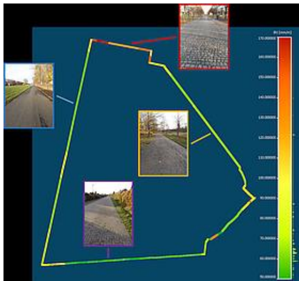
DARSTELLUNG DER AUS DEN LIDAR-DATEN BERECHNETEN RAUIGKEITSWERTE MIT FOTOS DER STRECKENABSCHNITTE
