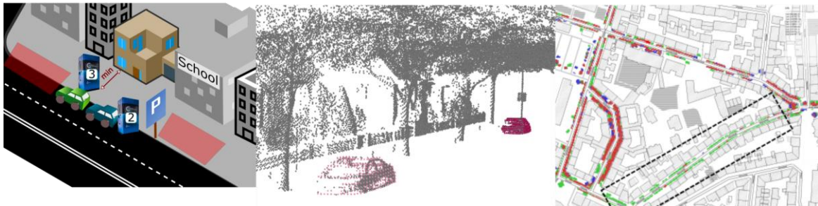
LINKS: MOBILE LADESÄULEN SOLLN NEBEN PARKENDEN FAHRZEUGEN POSITIONIERT WERDEN; MITTE: PARKENDE FAHRZEUGE EXTRAHIERT AUS EINER PUNKTWOLKE; RECHTS: INFORMATIONEN ÜBER PARKENDE FAHRZEUGE AGGREGIERT ÜBER DIE ZEIT
