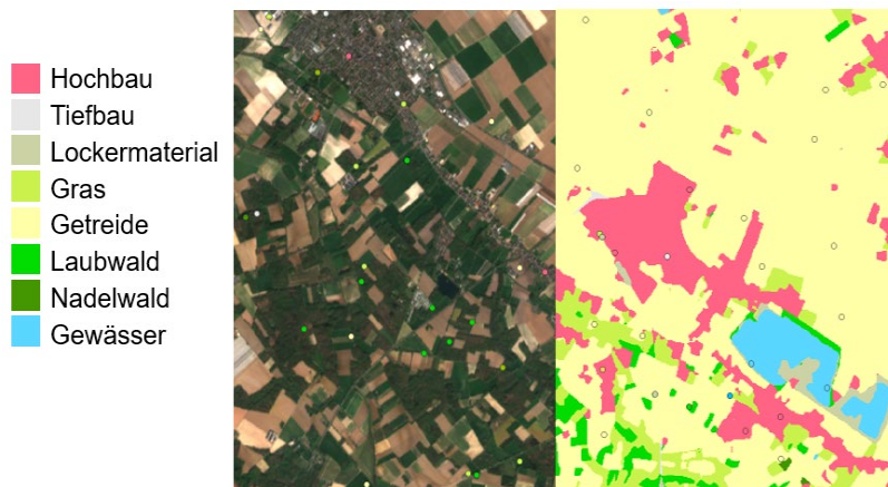
SATELLITENBILD (LINKS) UND ERGEBNIS DER LANDBEDECKUNGSKLASSIFIKATION (RECHTS)
